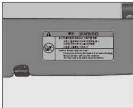
Hay una etiqueta de advertencia pegada en la visera del vehículo del lado del acompañante, para recordarle a usted y su acompañante de los peligros causados por las bolsas de aire frontales. Asegúrese de leer y seguir las instrucciones en esta etiqueta.
