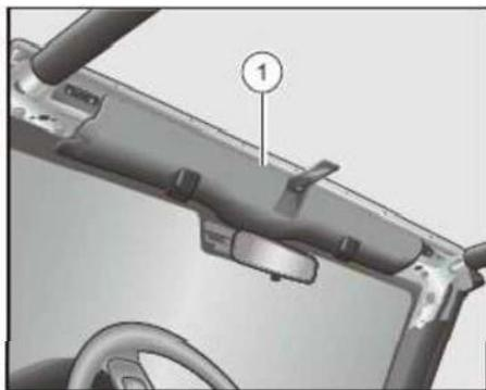
Retire el panel de corte de la viga superior -1- del parabrisas como se muestra en la figura.
