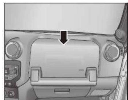
La bolsa de aire para el pasajero delantero se instala dentro del tablero de instrumentos encima de la guantera y su posición está marcada con la palabra "AIRBAG".
