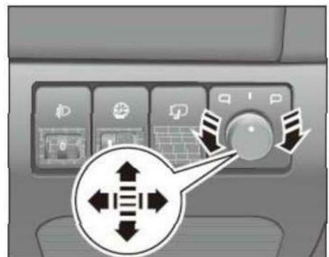
Los retrovisores exteriores son controlados por el interruptor de ajuste del espejo retrovisor. El interruptor de ajuste del espejo retrovisor se encuentra en la gama de interruptores del tablero en el lado del conductor.
