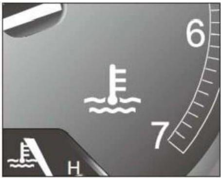
La luz de advertencia de refrigerante de motor (roja) se encuentra en el interior de tacómetro de motor. Cuando el refrigerante del motor está demasiado caliente, se encenderá esta luz de advertencia. En este momento, se debe estacionar su vehículo en un lugar apropiado como rápidamente como sea posible con seguridad, apague el motor, compruebe el nivel de refrigerante y vea si hay alguna fuga de la tubería de refrigerante.
