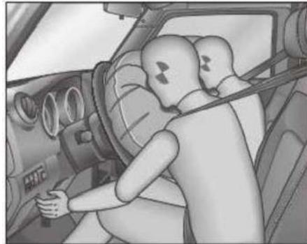
Cuando un vehículo está implicado en una grave colisión con un obstáculo, la bolsa de aire se abrirá rápidamente hacia fuera creando un cojín de aire completamente inflado para evitar daños de choque para el conductor y los pasajeros como resultado de la inercia.
