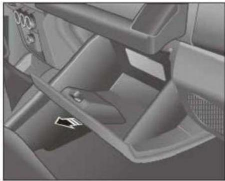
En primer lugar, retire la guantera del lado del acompañante: abra la guantera y tire lentamente hacia fuera en la dirección de la flecha que se muestra en la figura.
