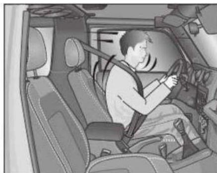
Usar cinturones de seguridad correctamente puede mantener el conductor y los pasajeros en la posición correcta y reducir las lesiones, también el usar correctamente el cinturón de seguridad puede evitar que el conductor y los pasajeros Continúen moviéndose de manera descontrolada y se pongan en peligro.
