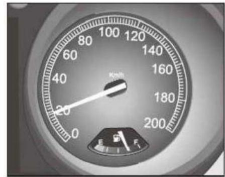
El Velocímetro muestra a velocidad actual de vehículo en Km/h
