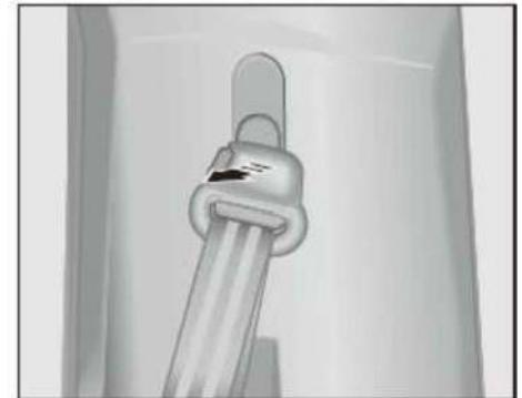
Para ello, es necesario primero quitar los ajustes de altura del cinturón de seguridad en ambos lados (la imagen aquí toma el lado derecho del vehículo como ejemplo). Tal como se muestra en la figura, levante y quite la carcasa exterior del ajustador de altura del cinturón de seguridad.
