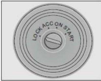
El interruptor de encendido se encuentra en el lado derecho de la columna de dirección. Como se muestra en la figura, el interruptor de encendido tiene un total de 4 posiciones:
