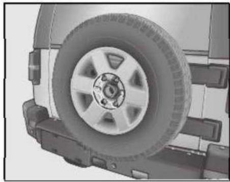
4. Alinee el orificio central de la rueda reemplazada con el perno en el hueco de la rueda de repuesto.
