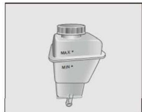
Cuando el motor está frío es el mejor momento para comprobar si el nivel de líquido de frenos está dentro del rango marcado en el lado del tanque de almacenamiento.
