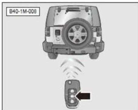
En el modo de antirrobo, pulse la tecla de puerta trasera para desbloquear la puerta trasera, el portón se cerrará otra vez después de que está abierto, y después de algún tiempo, será automáticamente bloqueado. Si la puerta no se abre después de algún tiempo después de presionar la llave de la puerta trasera, se bloqueará automáticamente y luego inmediatamente entrar en el modo de antirrobo.
