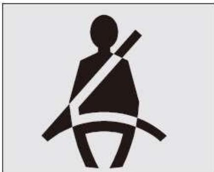
Si el interruptor de ignición se enciende pero el conductor no abrocha el cinturón de seguridad, se encenderá la luz indicadora de cinturón de seguridad en la pantalla del panel de instrumentos. Si el conductor no abrocha el cinturón de seguridad y la velocidad del vehículo supera los 25 kilómetros por hora, o cuando el vehículo se mueve hacia adelante una distancia de 500m o más de 60 segundos a una velocidad de 25km, luz de
