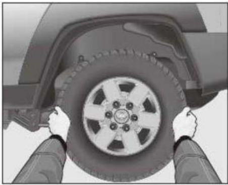
5 Alinee el orificio de instalación de la rueda de repuesto con el orificio de instalación en el disco de freno.
