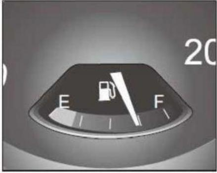
El indicador de combustible está situado bajo el odómetro. Cuando se gira la llave de encendido a la posición "ON", el indicador de combustible mostrará el volumen de combustible restante en el tanque de combustible. De "E" a "F", indica el cambio en la cantidad de combustible en el tanque de combustible, de vacío a lleno. Cuando la llave no está en la posición "ON", el puntero volverá a la posición E, y no se muestra el volumen actual de combustible restante.
