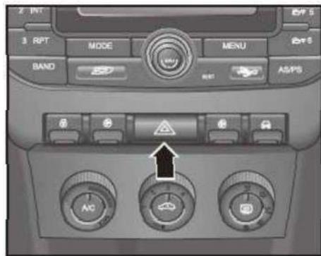
Como se muestra en la figura, el interruptor de luz de advertencia se encuentra dentro del panel de control central.
