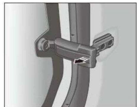
1. En la dirección de la -Flecha - como se muestra en la figura, tire de la manilla de bloqueo de la ventana del vehículo para cancelar el bloqueo de la posición.
