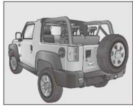
6. Levante ligeramente la cubierta del techo y muévala hacia la parte trasera del vehículo.
