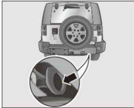
El anillo de tracción trasero (como se indica con la flecha) se instala en la placa soldada en la parte trasera del vehículo.
