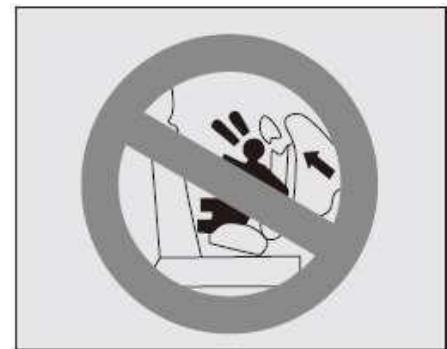
No instale un dispositivo de protección de niño mirando hacia atrás en el asiento delantero del vehículo. Si hace esto, en caso de que se desplieguen las bolsas de aire esta se impactara con la parte trasera del dispositivo de protección del niño con una fuerza muy grande, causando lesiones graves e incluso la muerte al niño.
