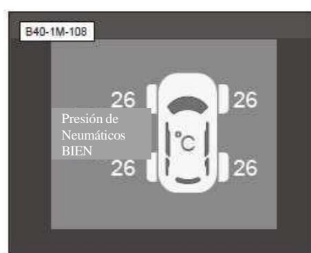
La interfaz se selecciona con interruptor de control en el centro de información, en el cual el conductor puede conocer la temperatura actual del neumático del vehículo.
