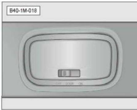
La luz de lectura se encuentra en el centro de la parte inferior del techo. Como se muestra en la figura, el interruptor de luz de lectura tiene un total de 3 posiciones:
