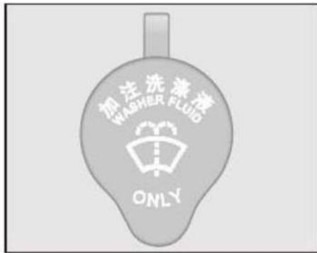
El líquido de lavado del parabrisas delantero y trasero se suministra desde el tanque de almacenamiento del líquido de lavado dentro del compartimiento del motor. Si se encuentra que el nivel del líquido de lavado es demasiado bajo, asegúrese de añadir rápidamente líquido de lavado en el tanque de almacenamiento.
