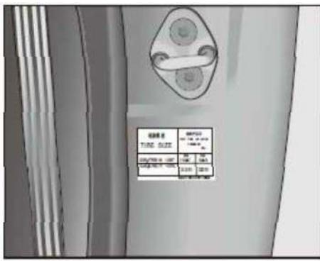
Una etiqueta de información del neumático se pega en el Pilar B del lado del conductor. Asegúrese de inflar los neumáticos de acuerdo con la presión de los neumáticos especificada en la etiqueta.
